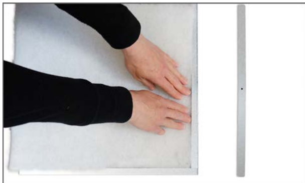
7. Paina kangas tiiviisti paikalleen ja työnnä reunat kehykseen. Aseta suodatin koneeseen mattopuoli ylöspäin.
