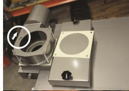
Oikealle, kiertosuunta myötäpäivään. Savutorvi käännetty ylösalaisin.
