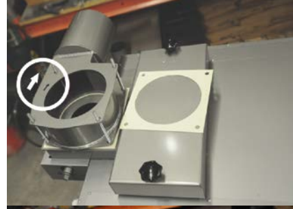
Oikealle, kiertosuunta myötäpäivään. Savutorvi käännetty ylösalaisin.
